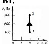
На рисунке показан переход газа из состояния 1 в состояние 2. Чему равно изменение внутренней энергии газа, если ему при этом сообщено 400 Дж теплоты.
