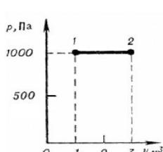
Определите величину работы, совершенной газом, при переходе из состояния 1 в состояние 2.
