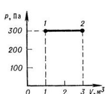
Определите величину работы, совершенной газом, при переходе из состояния 1 в состояние 2
