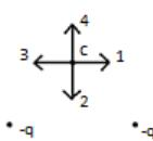
Какое направление имеет вектор напряженности в точке С электростатического поля двух одинаковых точечных электрических зарядов.
