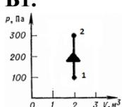
На рисунке показан переход газа из состояния 1 в состояние 2. Чему равно изменение внутренней энергии газа, если ему при этом сообщено 400 Дж теплоты.
